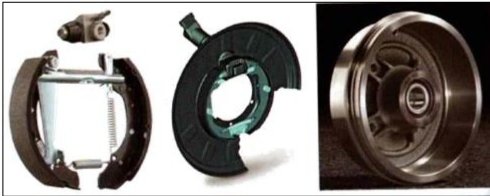
Figura 1.2 Zapatas, actuador hidráulico, tambor
