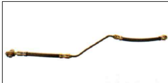
Figura 14.2 Tuberías y latiguillos
