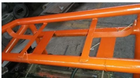
Figura 43-4: Soportes para el depósito de combustible
