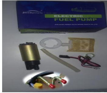
Figura 38-4: Bomba de combustible y sus elementos
