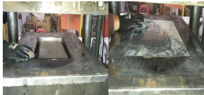
Figura 20-4: Lubricación de la Embutidora y del Material a Embutir
