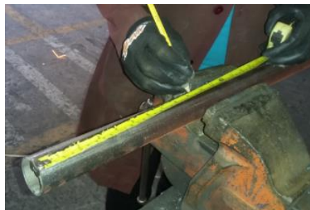
Figura 1-4: Marcado e inspección del material para los refuerzos
