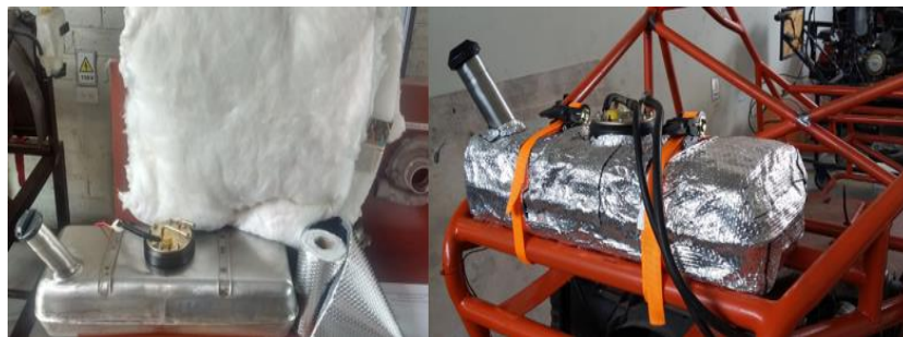
Figura 1-5: Recubrimiento del depósito de combustible con tela térmica
