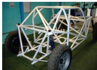
Figura 6-2: Chasis de estructura tubular
