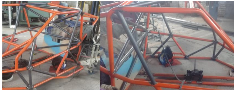
Figura 8-4: Construcción de Refuerzos Laterales
