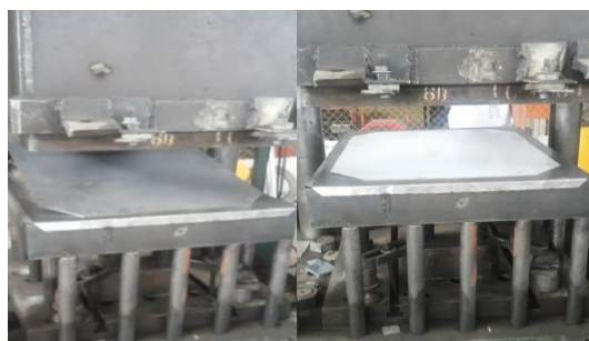
Figura 21-4: Inicio de la embutición del material
