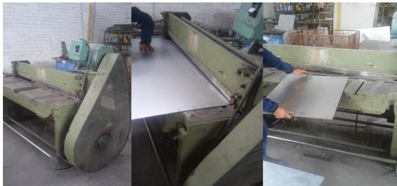
Figura 18-4: Corte de la pancha de acero inoxidable AISI 304 para la embutición
