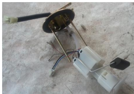
Figura 39-4: Adaptación la bomba de gasolina a la carcasa
