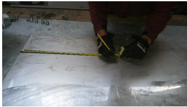
Figura 17-4: Trazado de las medidas para la embutición
