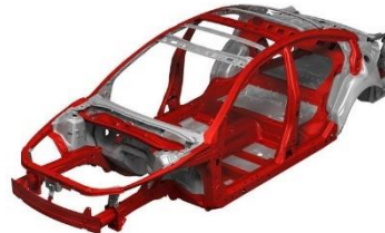
Figura 7-2: Chasis tipo monocasco
