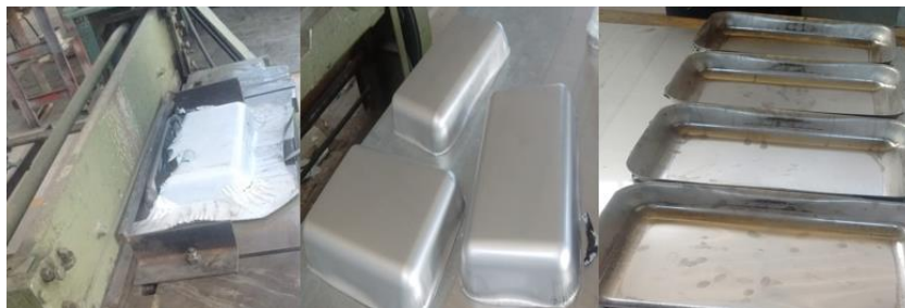
Figura 24-4: Recorte del exceso de material de los bordes de los moldes embutidos
