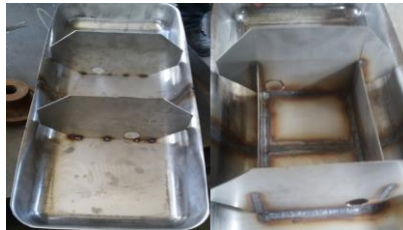
Figura 35-4: Soldadura del rompeolas
