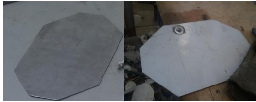
Figura 34-4: Paredes del rompeolas
