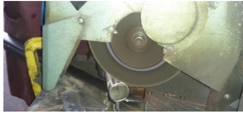
Figura 28-4: Corte del tubo de acero inoxidable AISI 304
