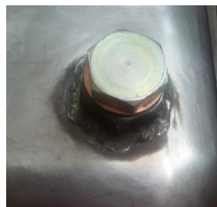
Figura 32-4: Tapón para el drenado de combustible
