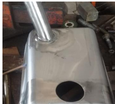
Figura 30-4: Soldadura de la toma de llenado sobre el molde superior
