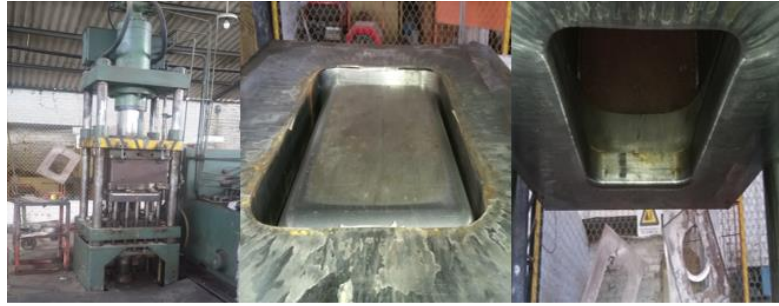
Figura 19-4: Embutidora, Matriz de Empuje y de Absorción
