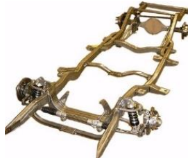
Figura 4-2: Bastidor tipo escalera
