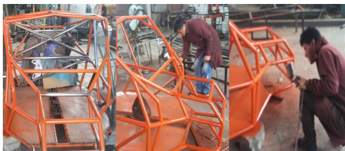
Figura 15-4: Pintado de la Estructura
