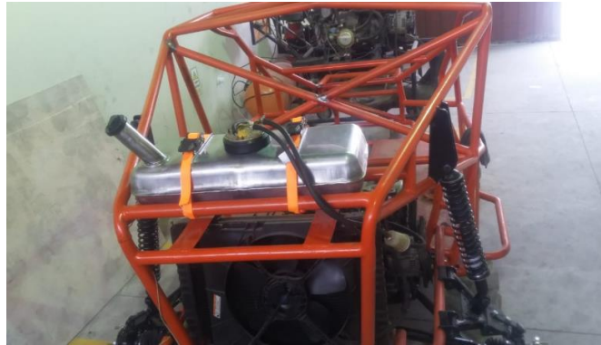
Figura 46-4: Instalación de los elementos de baja presión
