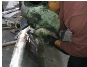
Figura 26-4: Unión de los bordes del cuerpo principal del depósito de combustible
