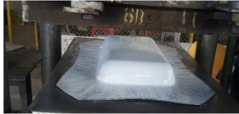
Figura 22-4: Embutición del material para el depósito de combustible
