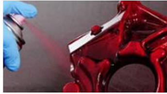
Figura 19-2: Ensayos de Tintas Penetrantes
