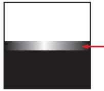
Figura 16-2: El acero inoxidable forma una capa de óxido de cromo
