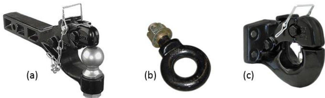
Figura 2-6. Tirones para remolque: (a) Tipo Bola (b) Tipo Ojo (c) Tipo Gancho
