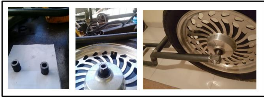
Figura 10-4: Acoplamiento de la rueda al neumático
