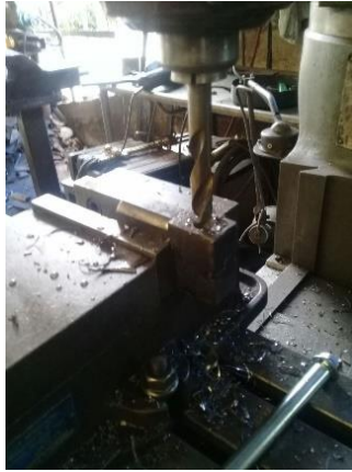
Figura 8-4: Perforación de elementos
