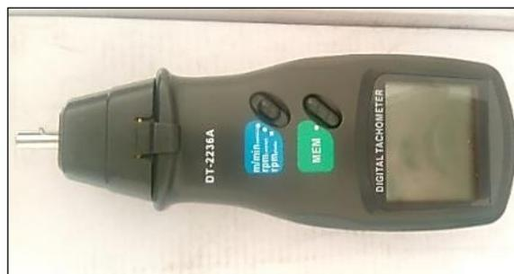
**Figura 9-5:** Tacómetro Digital
