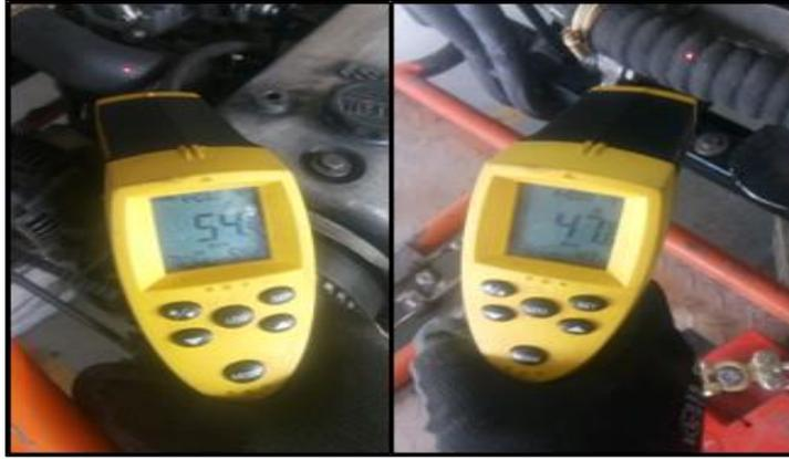
**Figura 5-5:** Temperatura de entrada y salida del refrigerante
