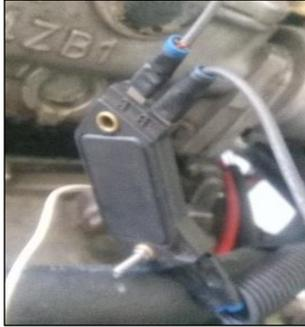
**Figura 6-4:** Conexión del módulo de encendido
