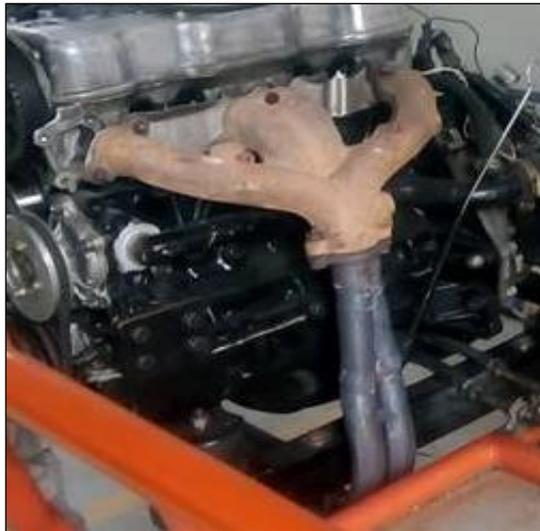
**Figura 4-4:** Adaptación del sistema de escape
