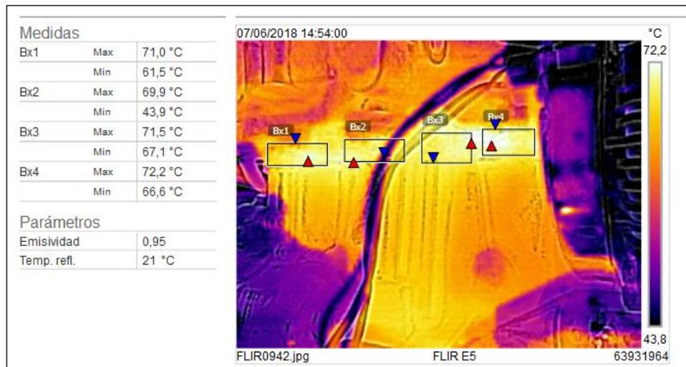
**Gráfico 4-5:** Termograma del bloque de cilindros en ralentí
