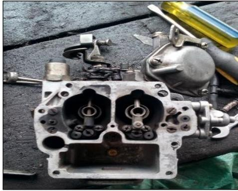
**Figura 14-3:** Desarmado del carburador
