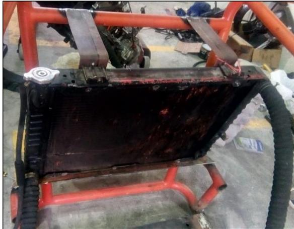
**Figura 5-4:** Adaptación del radiador
