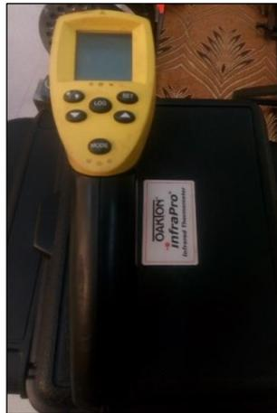
**Figura 3-5:** Pirómetro
