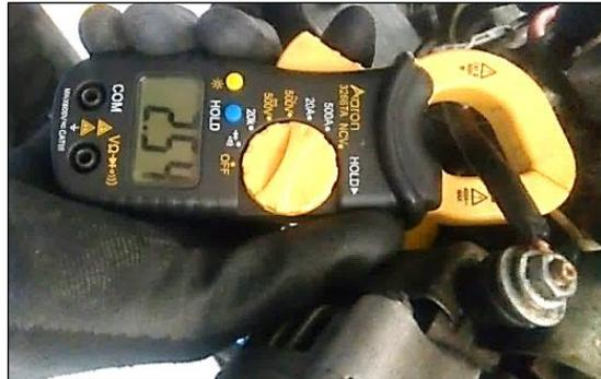
**Figura 13-5:** Medición del amperaje de carga
