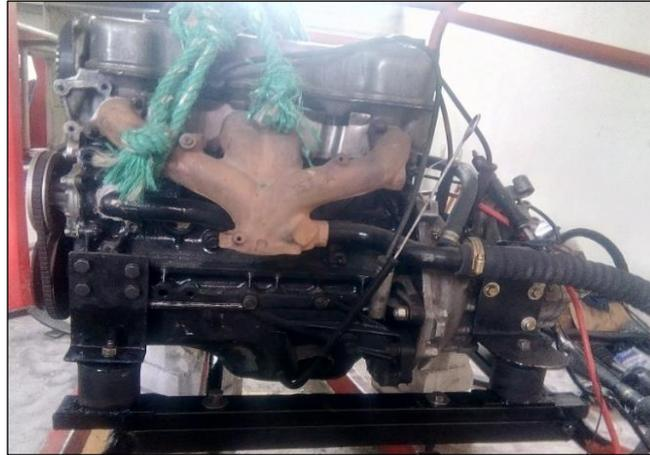
**Figura 3-4:** Adaptación del motor y el tren de potencia
