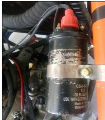
**Figura 7-4:** Conexión de la bobina
