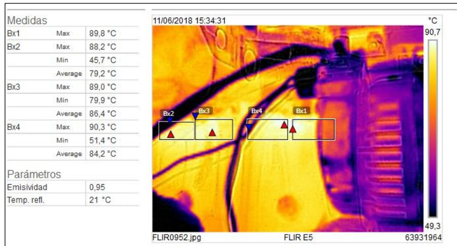
**Gráfico 9-5:** Termograma del bloque de cilindros a 3000 rpm
