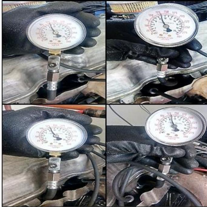
**Figura 7-5:** Compresión en los cilindros
