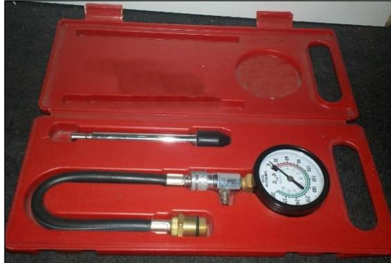
**Figura 6-5:** Medidor de Compresión
