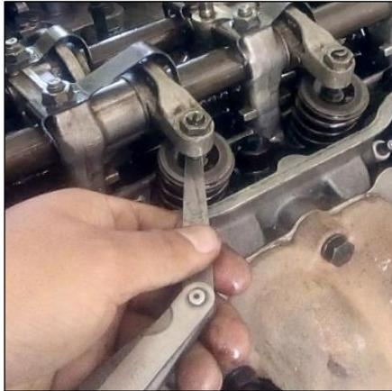
**Figura 12-3:** Calibración de válvulas
