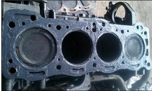
**Figura 10-3:** Colocación del empaque
