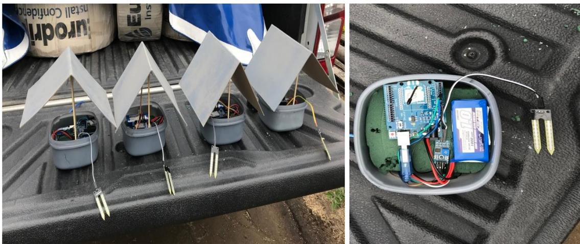
**Figura 4-3:** Sensores inalámbricos
