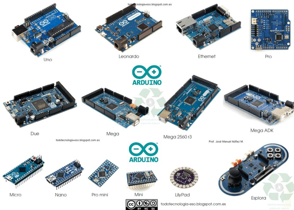
**Figura 12-2:** Modelos de placas Arduino
