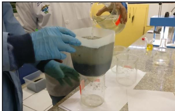
**Figura 5 – 2: Filtro de arena y carbón activado**
