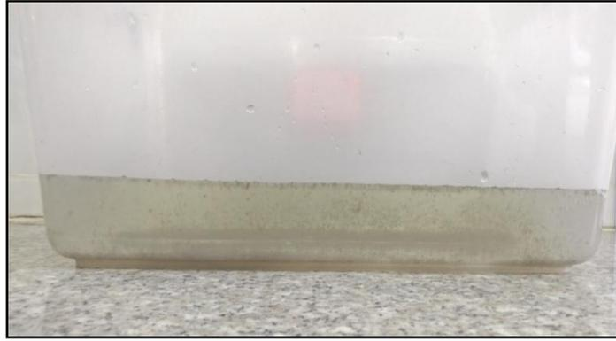
**Figura 4 – 2: Prueba de tratabilidad de Desarenador**
