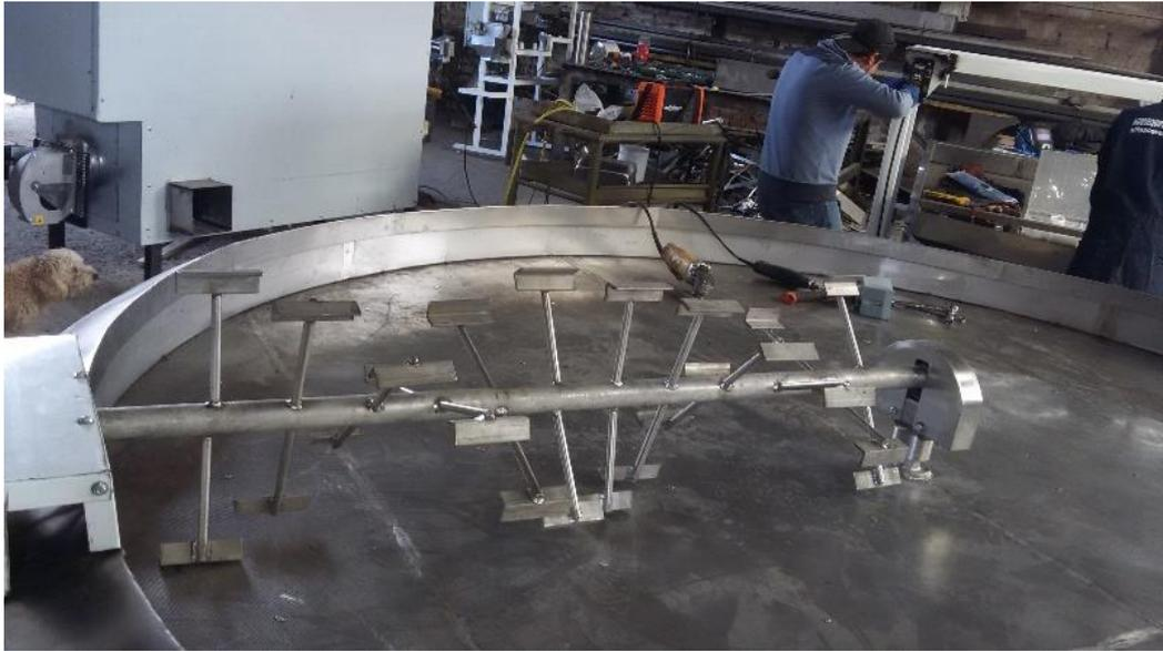
**Figura 19-2:** Ensamblado del eje de transmisión
