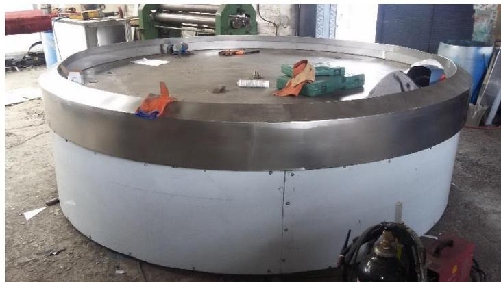
**Figura 18-2:** Ensamblado de la estructura móvil a la fija
