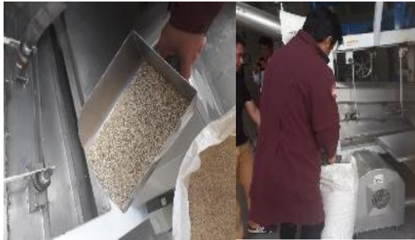
Ilustración 5-4 Alimentación a la zaranda dosificadora. Realizado por: Juan Carlos Shunta, 2018
