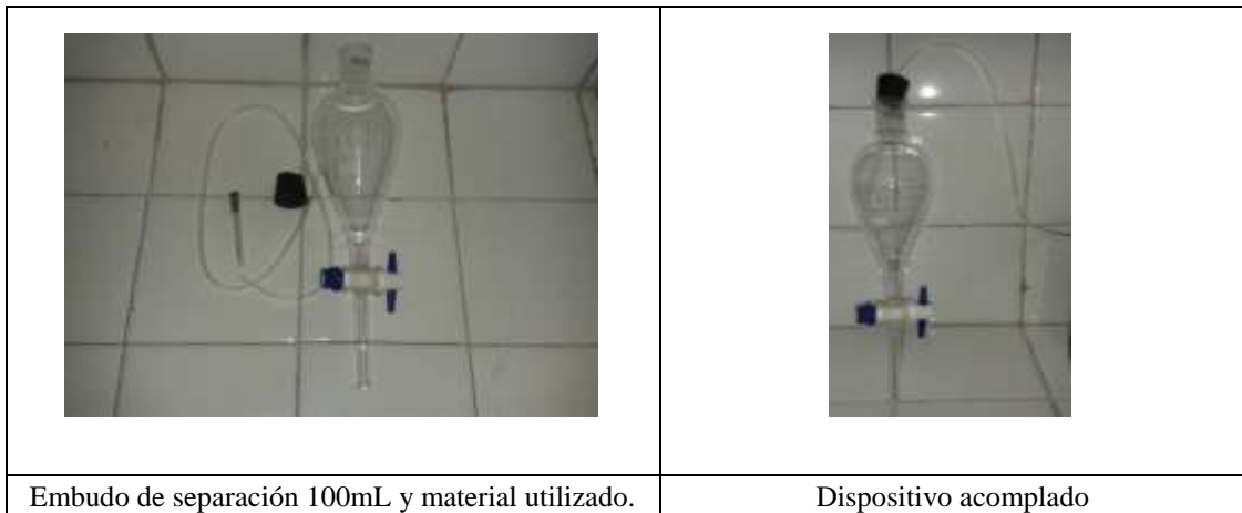
Fotografía 3-4: Embudo de separación de 100 mL y material de laboratorio.
