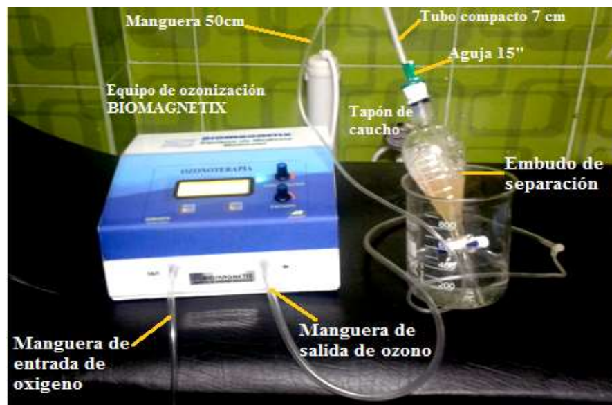
Fotografía 1-3: Dispositivo para tratamientos de ozonización
