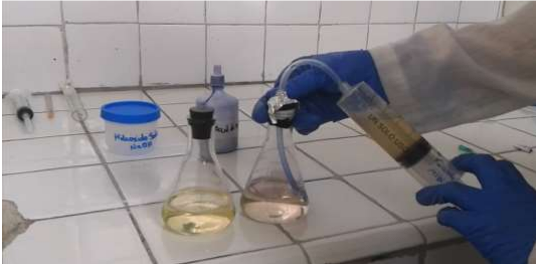
Fotografía 4-3: Expulsión de oxígeno de las jeringuillas fermentadas.
