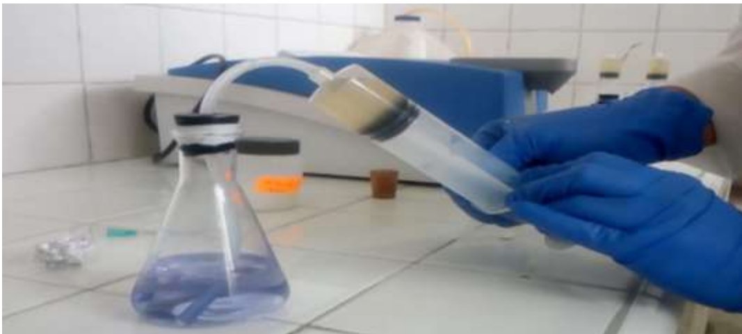
Fotografía 5-3: Coloración azul pálido, (azul de metileno oxidado), provocada por el oxígeno producto de la degradación del ozono.
