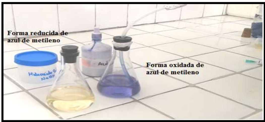
Fotografía 3-3: Reducción de azul de metileno con glucosa en medio alcalino
