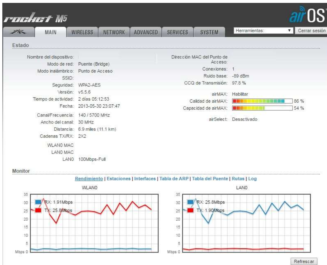
Figura 16-3: AP del enlace Nodo Principal-Llatantoma con IEEE 802.11 a
