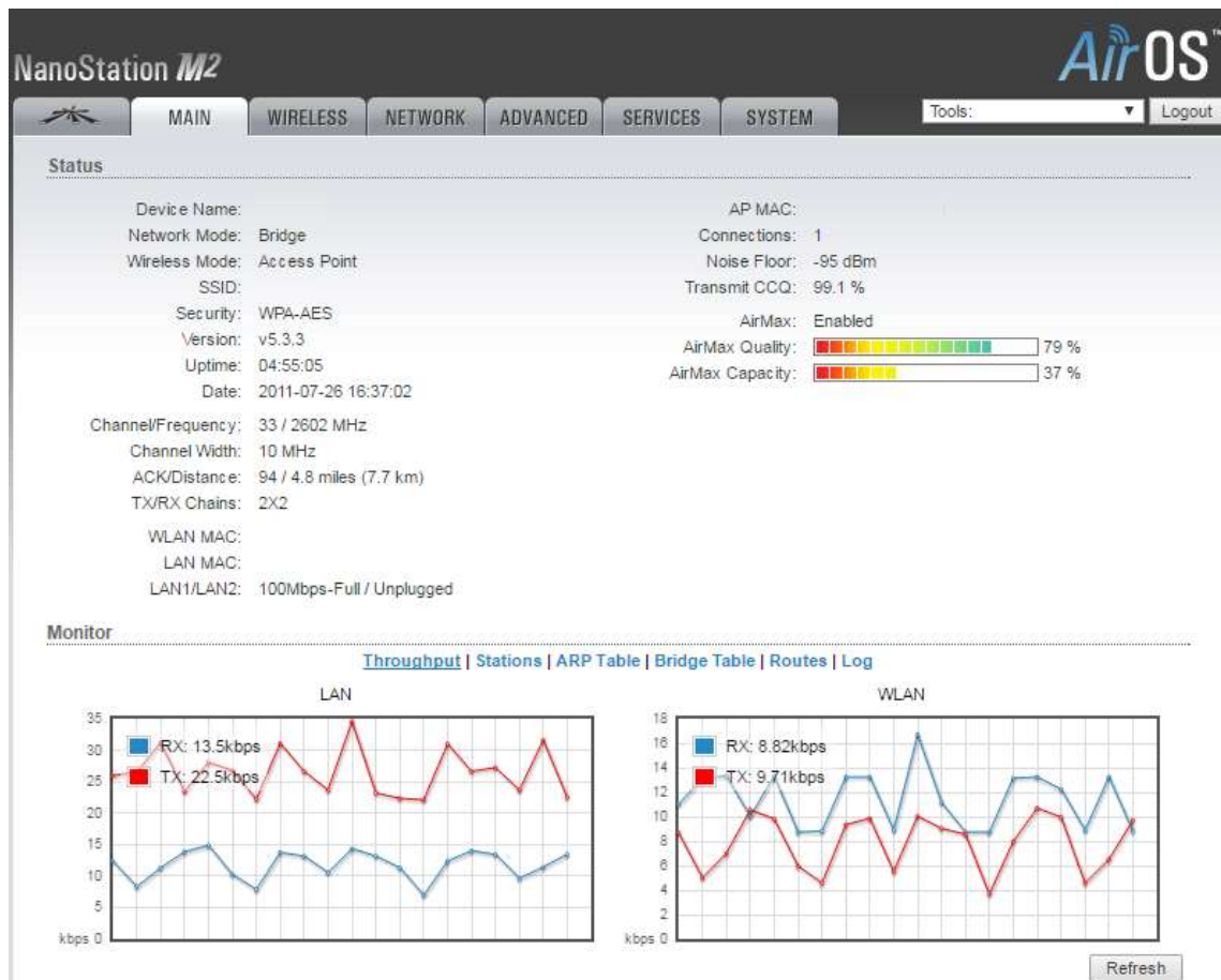
Figura 18-3: AP del enlace Nodo Principal-Lacón con IEEE 802.11 b
