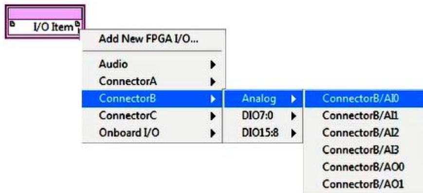
Figura 3. 66: Declaración de la entrada analógica para el transductor de presión.
