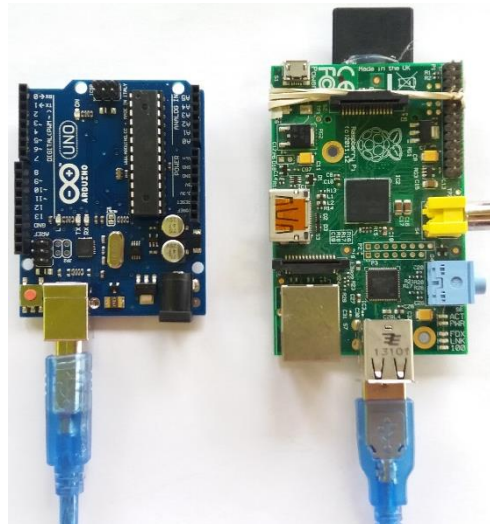
Figura 28-4: Conexión serial entre Arduino y Raspberry Pi Fuente: Autores
