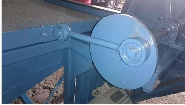
Figura 7-5: Sistema de transmisión de potencia
