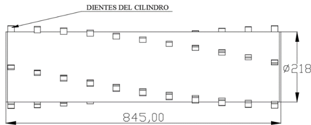
Figura 55-4: Dimensiones geométricas del cilindro acelerador de mieses
