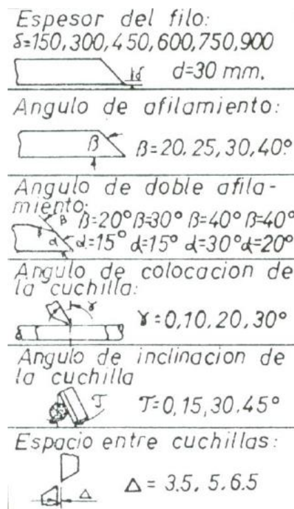
Figura 9-4: Parámetros geométricos de las cuchillas en cosechadoras de caña.
