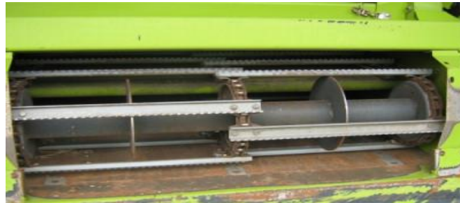
Figura 18-2: Acarreador Fuente: (PRECOP, 2010)
