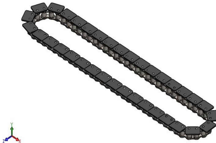
Figura 11-4: Modelación en 3D de la cadena alimentadora del cabezal
