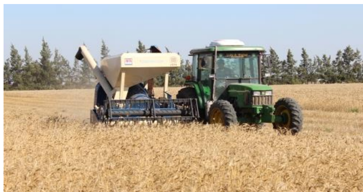
Figura 12-2: Cosechadora de arrastre Fuente: (AGROTERRA, 2012)
