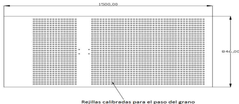
Figura 70-4: Tamiz para limpieza de grano
