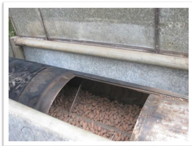
Ilustración 41: Detalle del interior del tambor de la tostadora de Cacao Fuente: Juan Pablo Aguilar, 2011.
