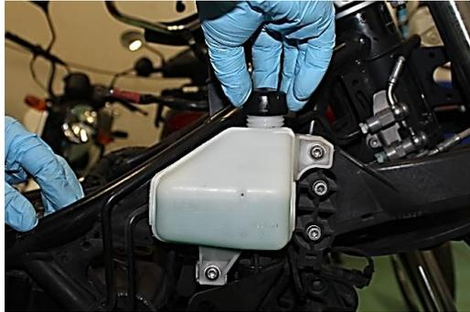
**Figura 19-2:** Depósito de refrigerante de motocicleta
