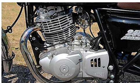
**Figura 20-2:** Motor mono cilindro en motocicleta 250 cc
