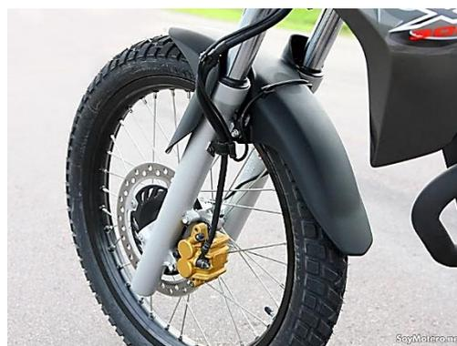
**Figura 28-2:** Disco de freno de doble pistón
