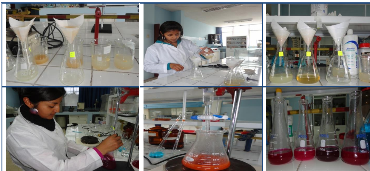
Preparación de muestras, filtrado y titulación para determinación de azúcares totales (carbohidratos)
