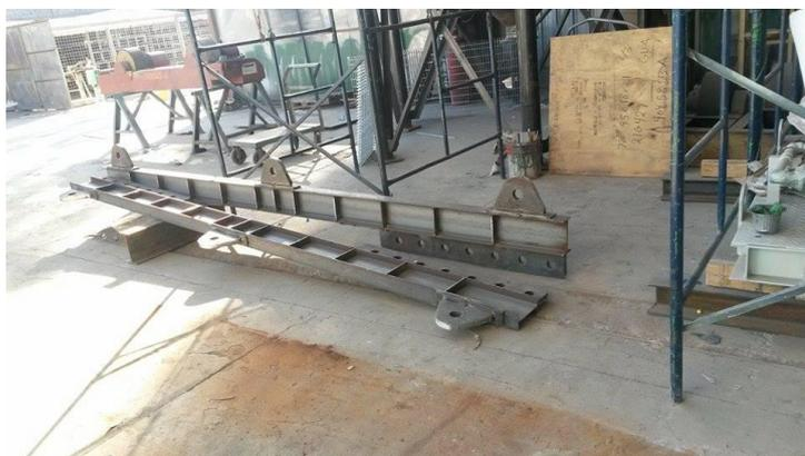
**Anexo 4 Intercambiado en proceso tipo de suelda SMAW ESPESOR 38 MM-A36**
