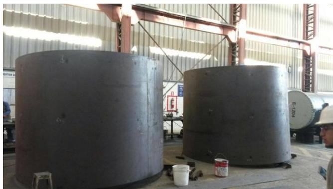
**Anexo 7 Tanque en proceso tipo de suelda SMAW ESPESOR 19 MM-SA516**
