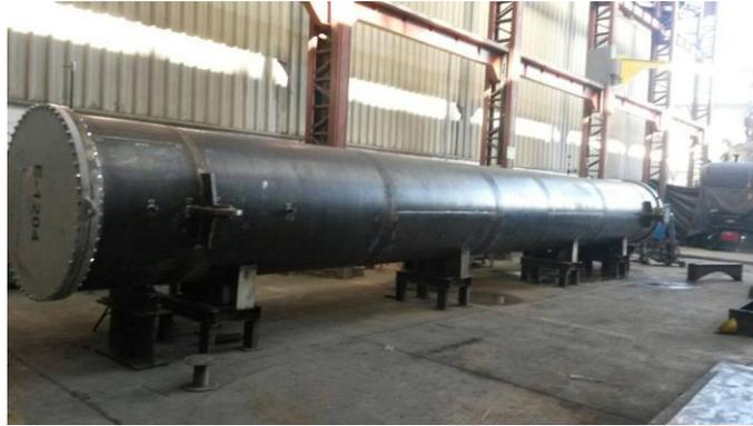
**Anexo 5 Tanque en proceso tipo de suelda SMAW ESPESOR 19 MM-SA516**
