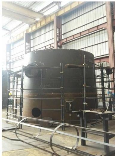
**Anexo 9 Puntos de suelda tipo GTAW 16 MM-SA516**
