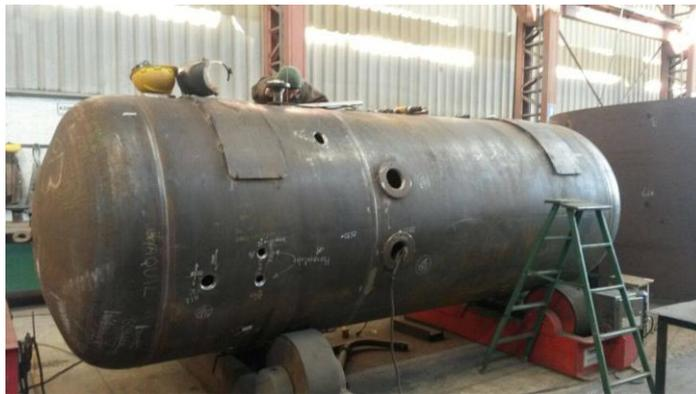
**Anexo 6 Tanque en proceso tipo de suelda SMAW ESPESOR 19 MM-SA516**
