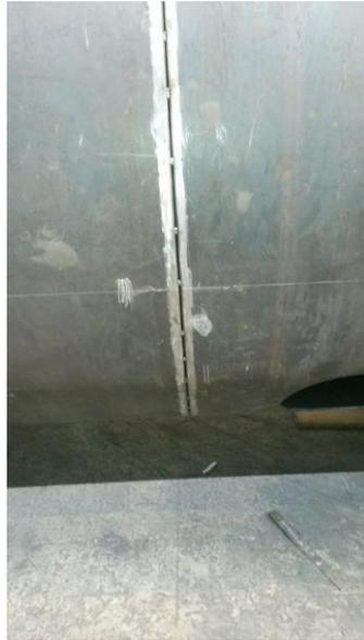
**Anexo 10 Brida en proceso tipo de suelda SAMW ESPESOR 38MM-A36**
