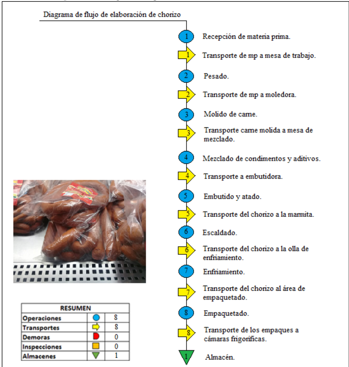
Figura 4-3. Diagrama de proceso de elaboración del chorizo
