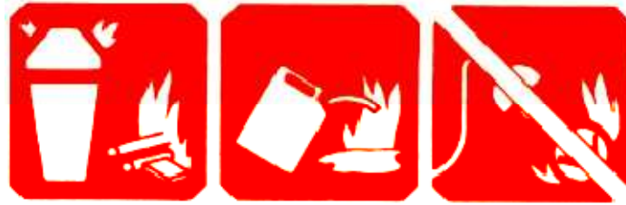
Figura 40: Usar solo Extintores para Fuego Clase “A y B”
