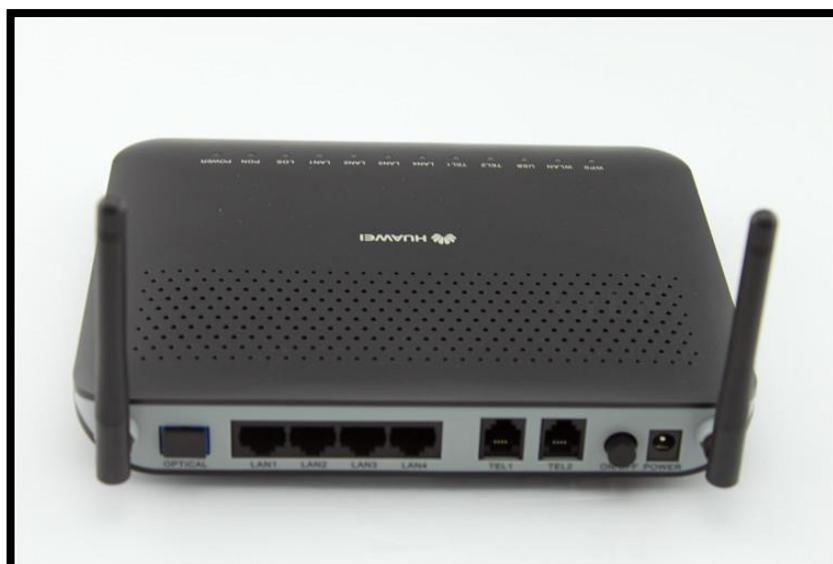
Figura 3-3: ONT Huawei HG8245. Realizado por: Iván Tenecora, 2019
