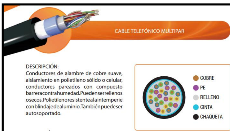
Figura 16-2: Cable multipar telefónico.
