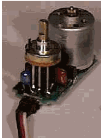
Figura 3.6: Circuito típico de control servomotor
