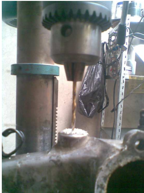
Figura 5.2: Perforación del múltiple de admisión
