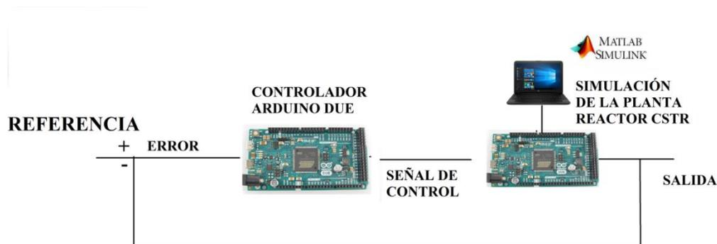
**Figura 5-2.** Diagrama de bloques simulación HIL del presente proyecto.
