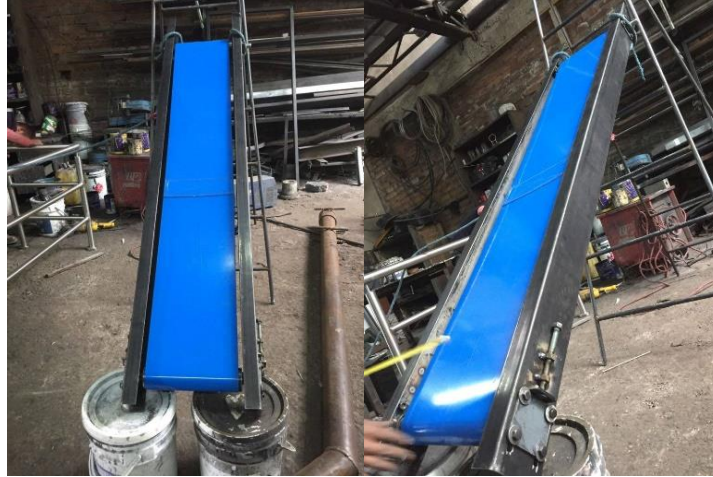
Figura 19-4. Tensión de las bandas
