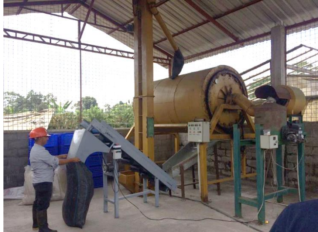
Figura 23-4. Implementación de la banda transportadora
