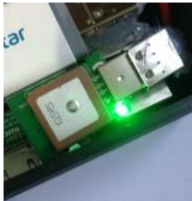
Figura 21-3: Modulo GPS en funcionamiento
