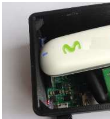
Figura 22-3: Modulo GPRS en funcionamiento
