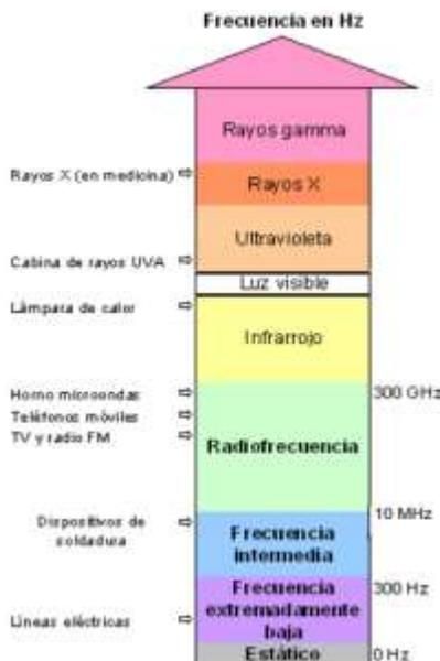
**Figura 8-1:** Espectro de la radiación no ionizante
