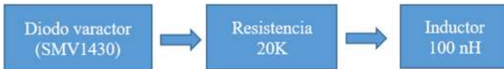
Figura 19-2: Diagrama de bloques del sistema de protección del diodo varactor
