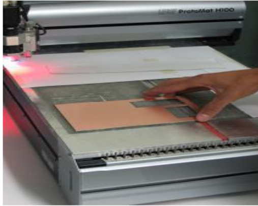
Figura 27-2: Fresadora laser Realizado por: CUDCO, José 2018
