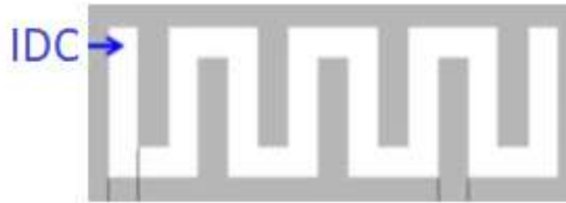
Figura 7-2: Diseño del IDC Realizado por: CUDCO, José 2018
