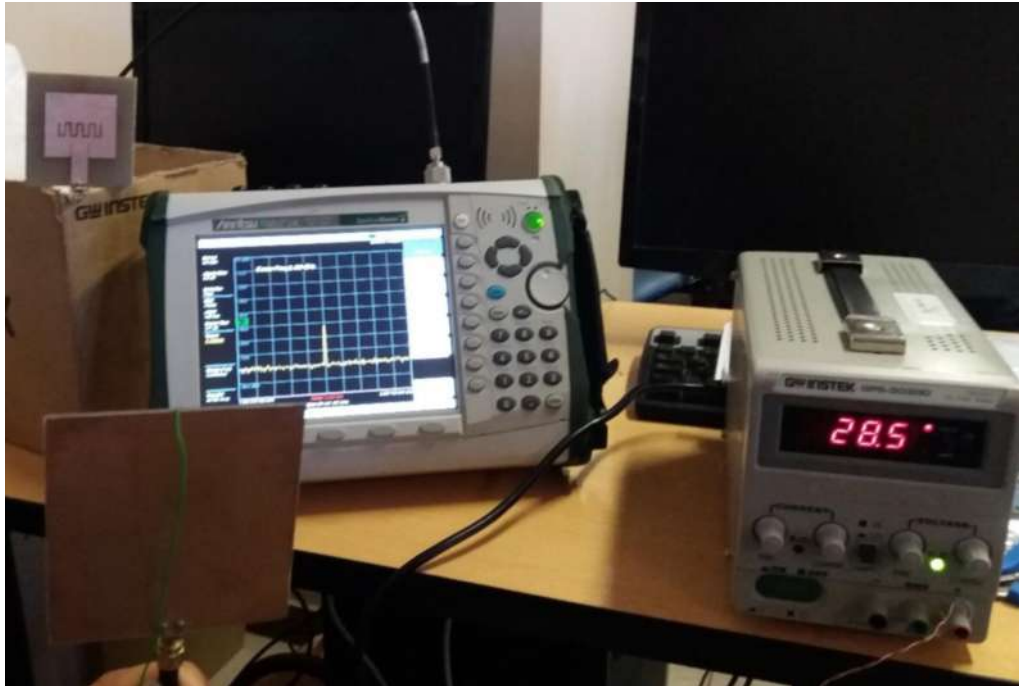
Figura 13-3: Determinación del patrón de radiación Realizado por: CUDCO, José 2018
