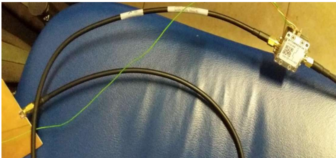
Figura 31-2: Conexión con el Bias Tee Realizado por: CUDCO, José 2018
