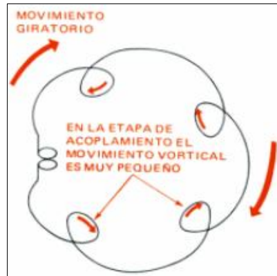
Figura 2-6: Punto de acoplamiento Fuente: Ford Motor Co.
