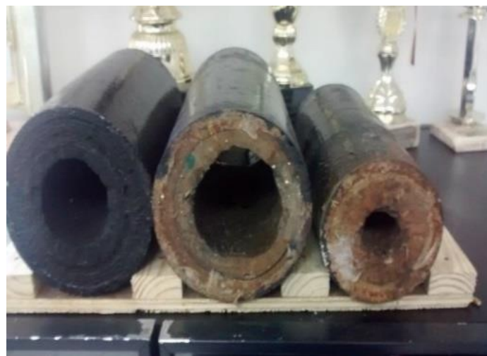
Figura 4-2: Corte de Tuberías y efectos por la inyección inadecuada de químicos Fuente: Departamento de Producción Secoya
