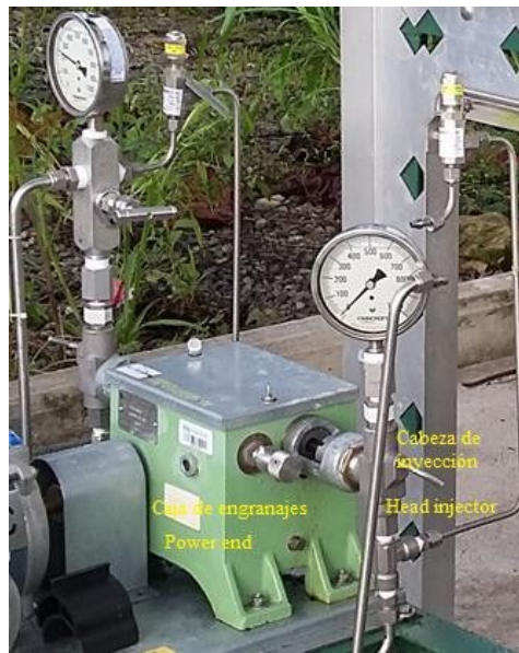
Figura 16-4: Power End y Fluid End Realizado por: Mancero, Ernesto, 2017
