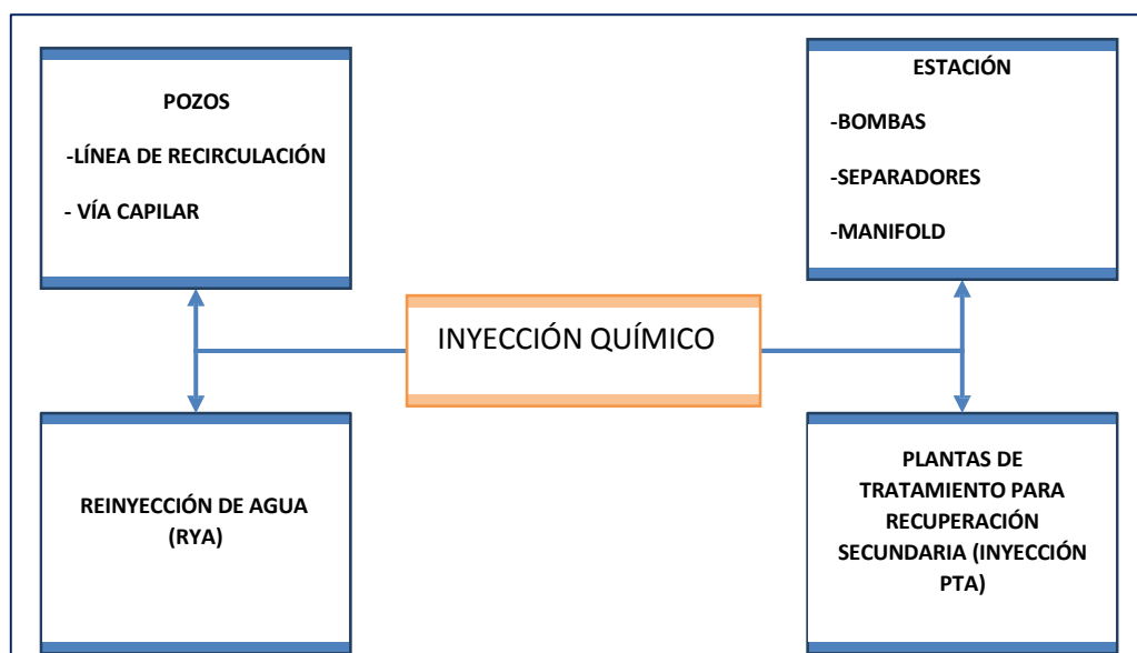
Figura 1-2: Puntos de Inyección de Químicos Realizado por: Mancero, Ernesto, 2017
