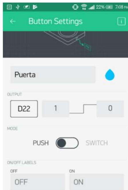
Para cambiar entre modo switch y modo pulsado se debe pulsar dos veces sobre el botón para configurarlo.
