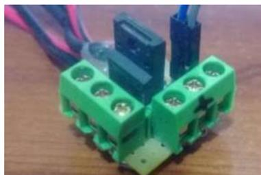
**Figura 21-2:** Circuito de distribución de energía
