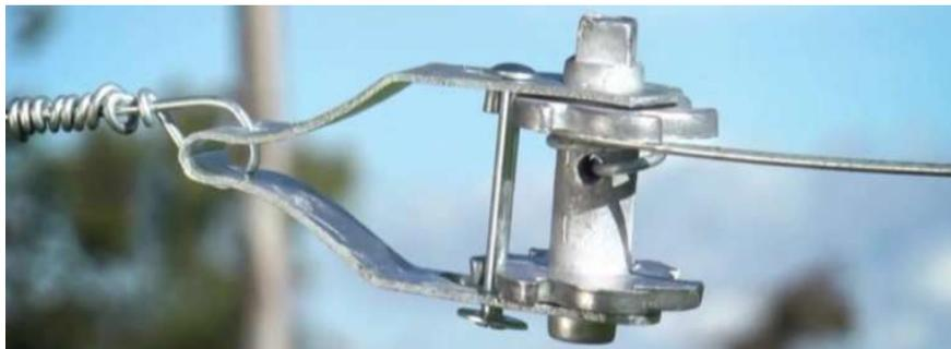
**Figura 13-1:** Tensor metálico de cerca
