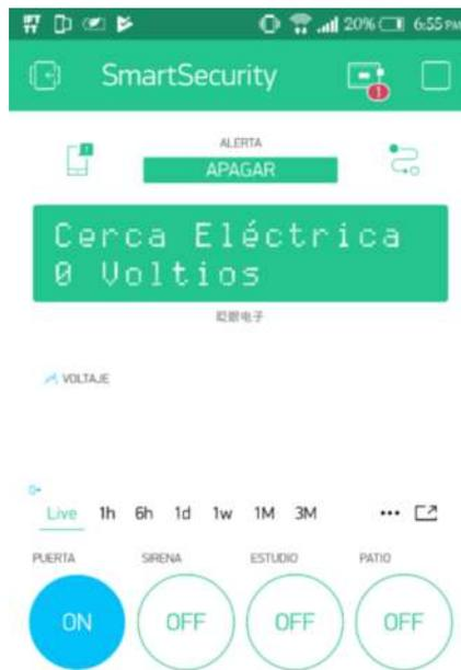
Basta con presionar sobre el botón deseado para accionar uno de los relés ya sea en modo switch o modo pulsador. Lo cual queda a criterio del usuario.
