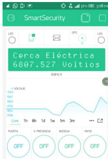
Se muestra la pantalla de inicio de la aplicación en la cual bien por defecto configurado 4 salidas para cada uno de los relés de la central de gestión.
