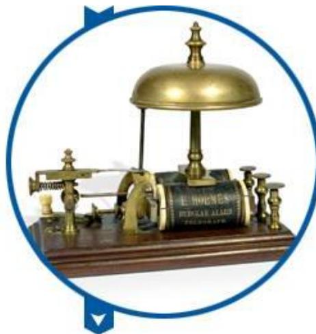
**Figura 2-1:** Prototipo de Pope alarma electromagnética
