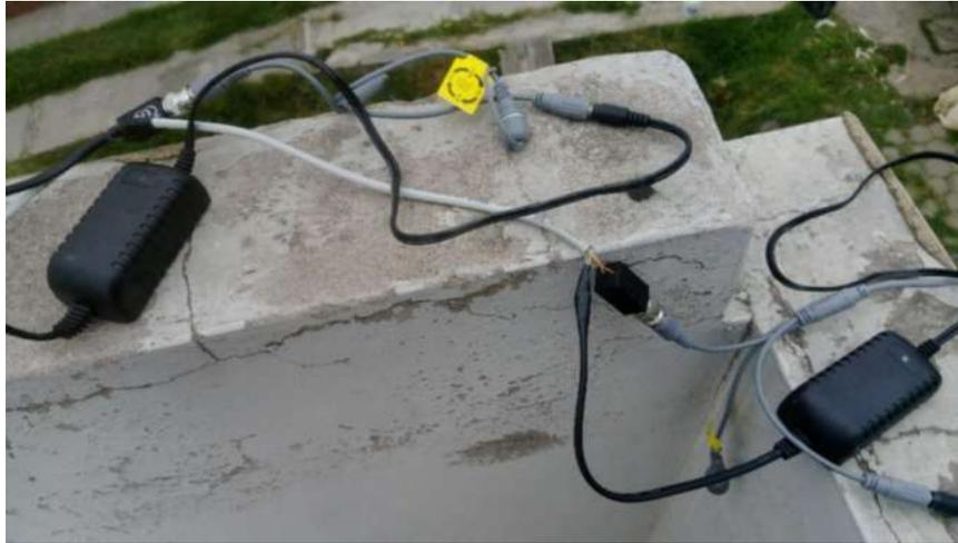
**Figura 50-2:** Conexión cable PoE – cámaras de video vigilancia
