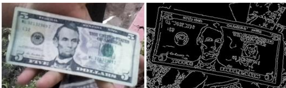
Figura 26-2: Imagen en RGB y detección de bordes
