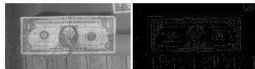
Figura 16-2: Imagen en escala de grises y aplicado LBP invariante a la rotación
