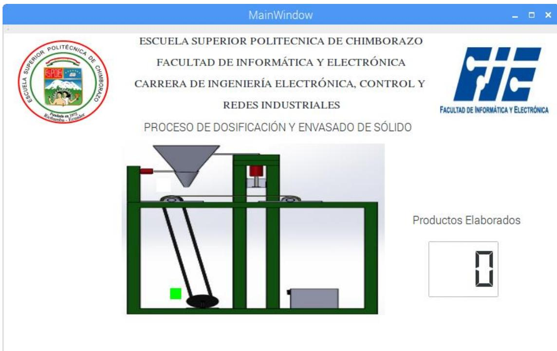
**Figura 11-3** Monitoreo funcionalidad de la banda transportadora
