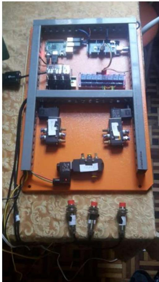
**Figura 8-3** Tablero eléctrico & electrónico implementado
