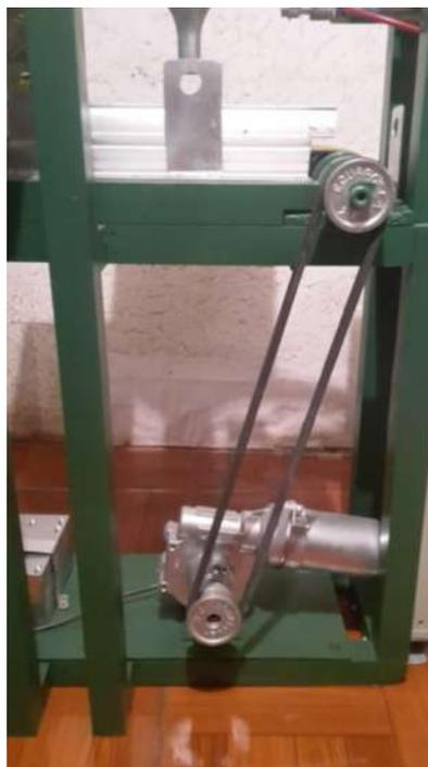
**Figura 5-3.** Trasmisión de movimiento a la banda transportadora.
