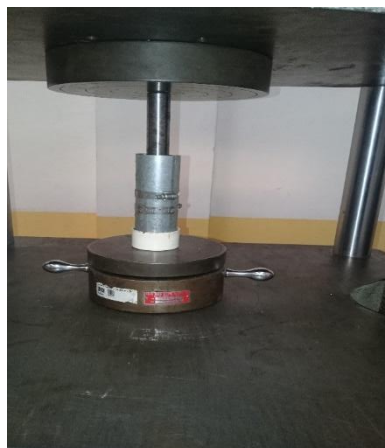
Figura 1-4: Ensayo de compactación en la máquina universal
