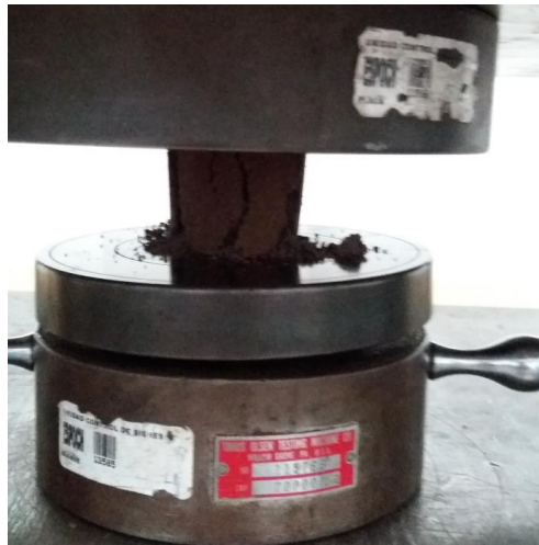
Figura 8-5: Aplicación de carga a la briqueta
