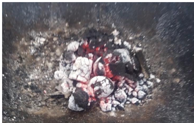
Figura 14-5: Formación de carbón de las briquetas
