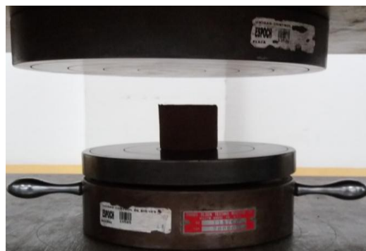
Figura 7-5: Ubicación de la briqueta en la máquina universal
