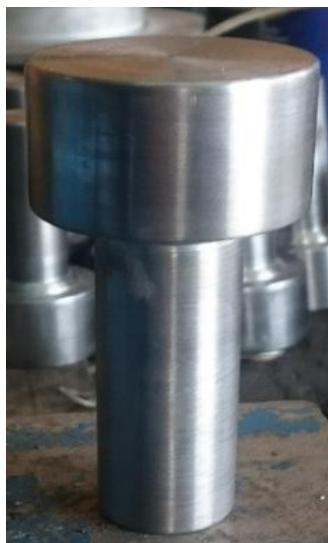
Figura 21-4: Pin de compactación
