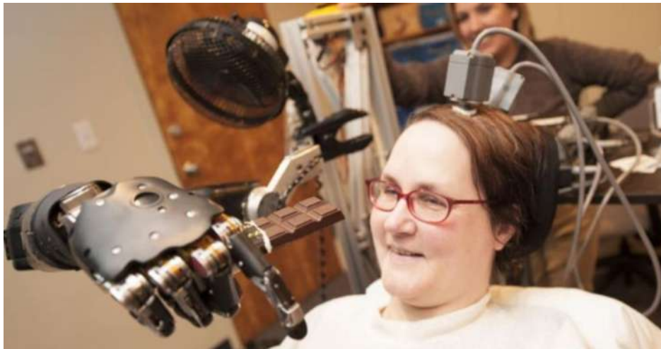
Figura 21-1: Mano robótica controlado con BCI invasivo
