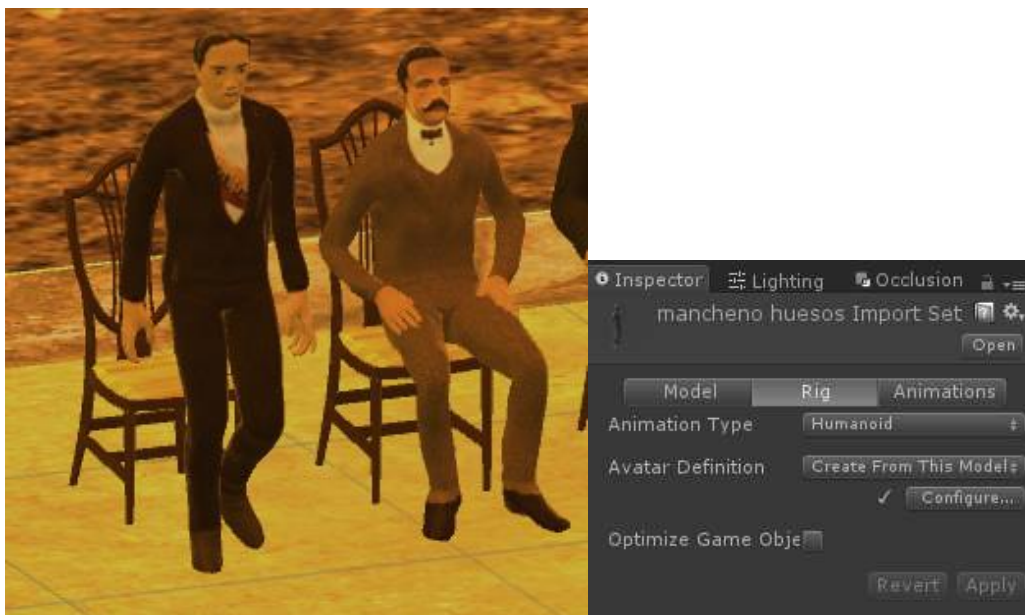
Figura 25-3: Ventana para riggear modelados 3D
