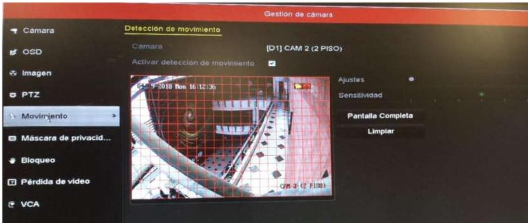
**Figura 3-53:** Detección de movimiento de cada cámara IP
