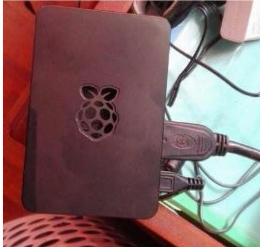
**Figura 4: Cables HDMI y cargador de alimentación conectados a la Raspberry.**
