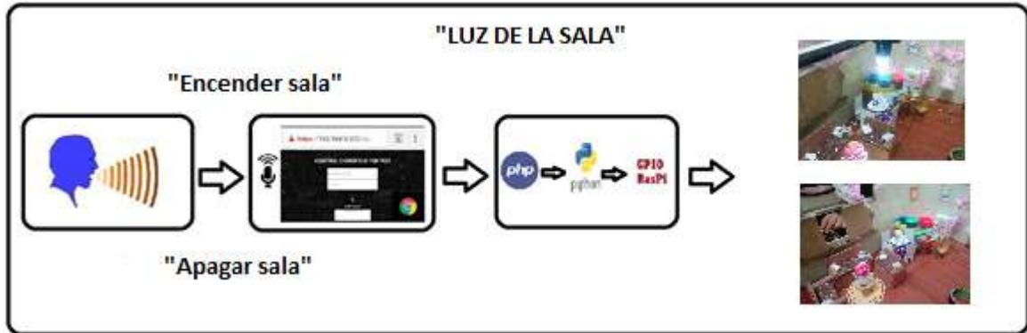
**Gráfico 4-3: Encendido y apagado de la luz de la sala.**
