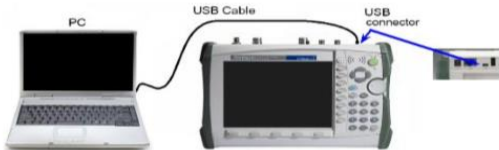
Figura 19-2. Comunicación PC – Analizador de Espectros Anritsu modelo MS2724C
