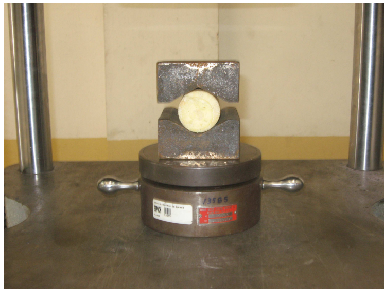
Figura 3.2. Ensayo de compresión transversal del palmito
