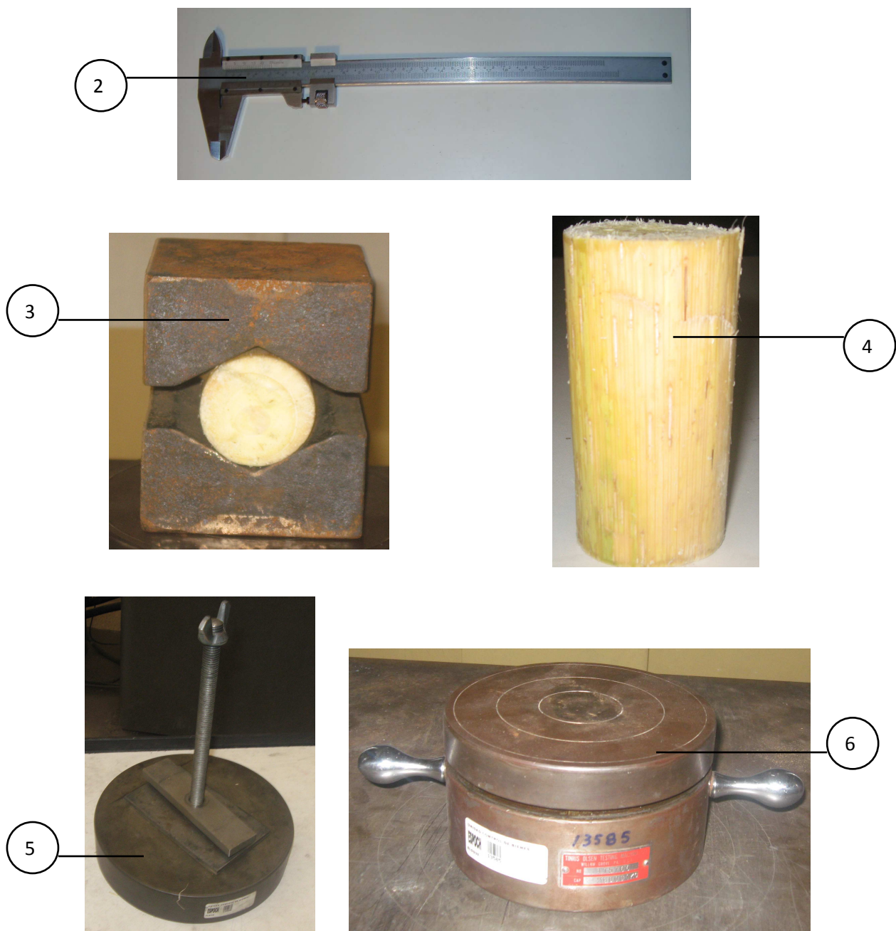
Figura 3.1. Materiales y equipos utilizados en el ensayo de compresión transversal del palmito
