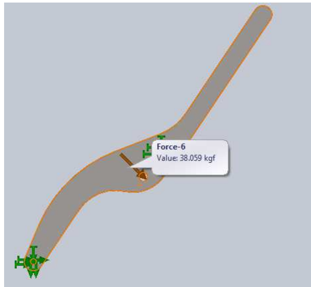
Figura 5.11. Cargas aplicadas en el eslabón al inicio del centrado.
