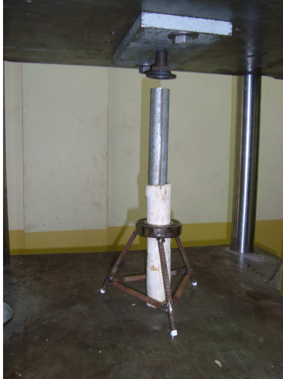
Figura 3.4. Ensayo de corte longitudinal del palmito
