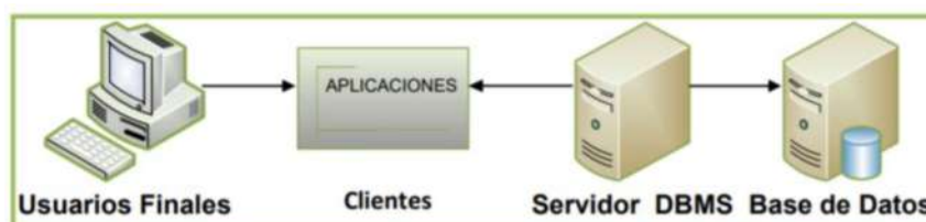
Figura 2-1: Modelo de Aplicación Cliente – Servidor
