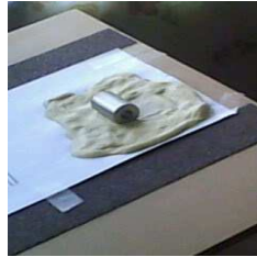
Figura 4.1. Plano inclinado para determinar el coeficiente de rodadura
