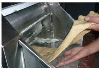
Figura 7.4. Masa laminada con imperfecciones
