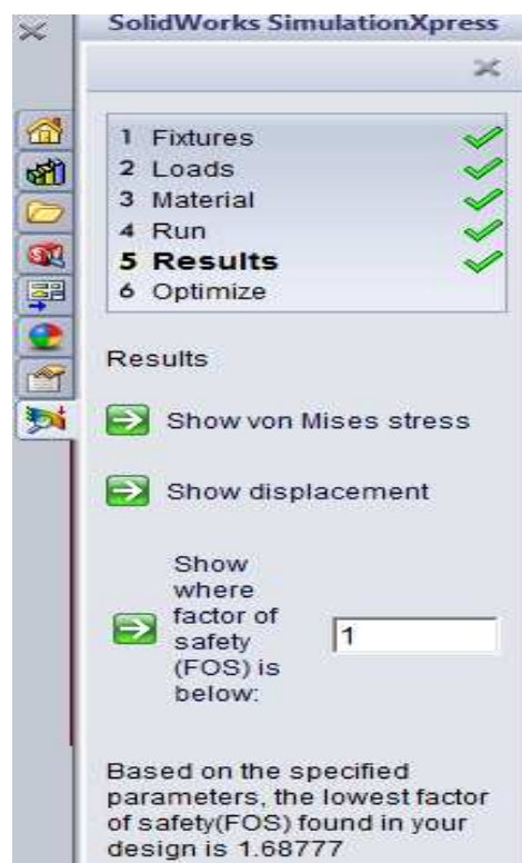
Figura 4.54. Factor de seguridad de la plancha derecha superior
