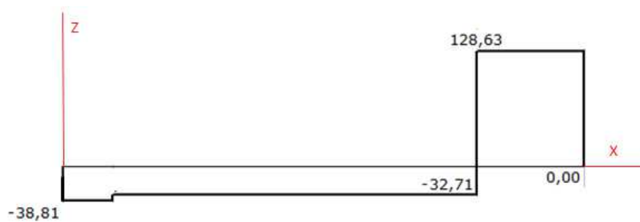
Figura 4.23. Diagrama de fuerza cortante, plano xz para diseño del eje excéntrico
