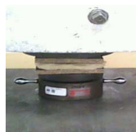
Figura 4.2. Masa deformada con máquina universal
