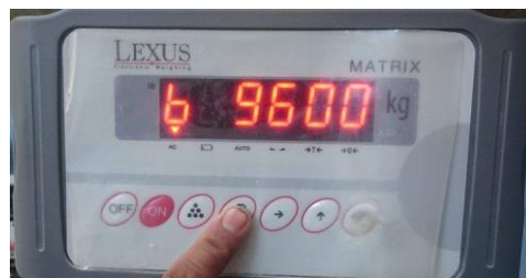
Figura 3-12. Velocidad de comunicación por puerto serial. Fuente: Autores.
