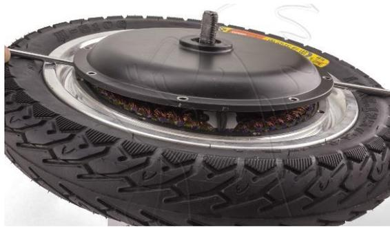
**Figura 1-4:** Motor eléctrico Brushless trifásico sincrónico, con rotor de imanes permanentes.
