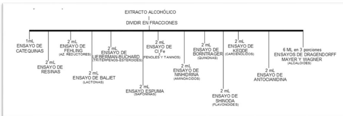
**Figura 4-2:** Esquema de ensayos del extracto alcohólico.
