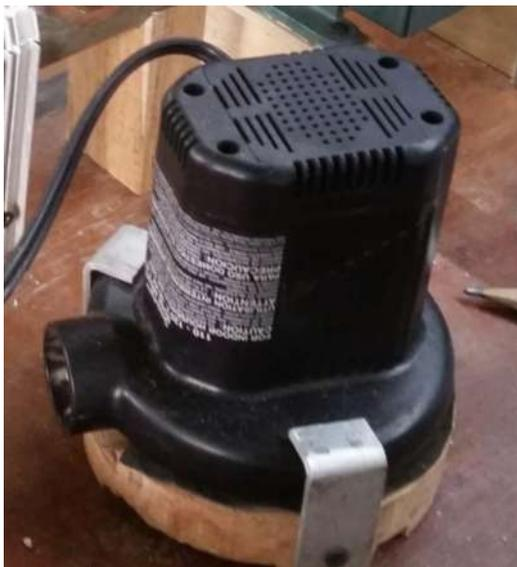
El ventilador centrífugo posee una salida de aire tangencial a su eje.
