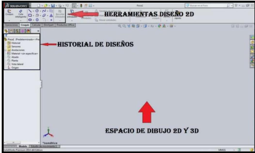
**Figura 27-1** Pantalla para diseño 2D y 3D
