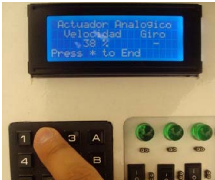
Figura.V.60. Control desde el teclado de la TDDC de la Velocidad PWM de un motor Fuente: Los Autores
