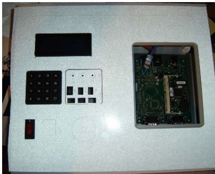
Figura.III.37. Colocación del acabado de la parte superior del Laboratorio TINÍ. Fuente: Los Autores
