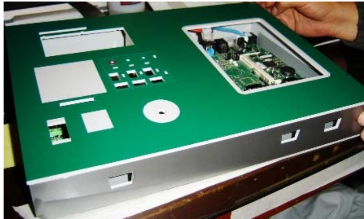
Figura.III.36. Comprobación de las medidas de armado de la caja. Fuente: Los Autores
