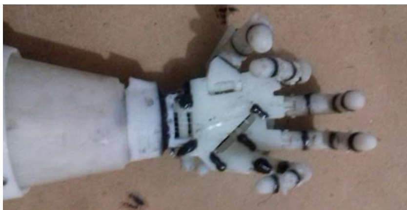
Figura 7-3: Prótesis escalada al 35,3 % de la escala real cerrado de mano
