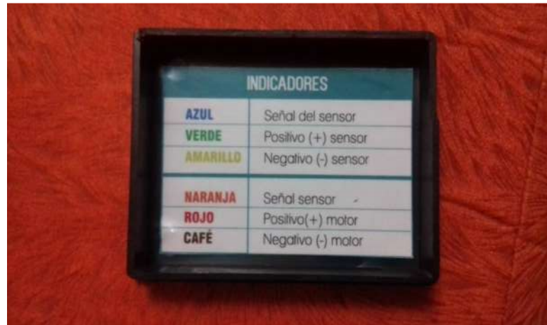
Figura 45-2: Descripción de cables de conexión según sus colores.
