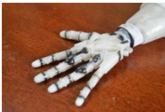
Figura 22-2: Resortes simulación de tendones
