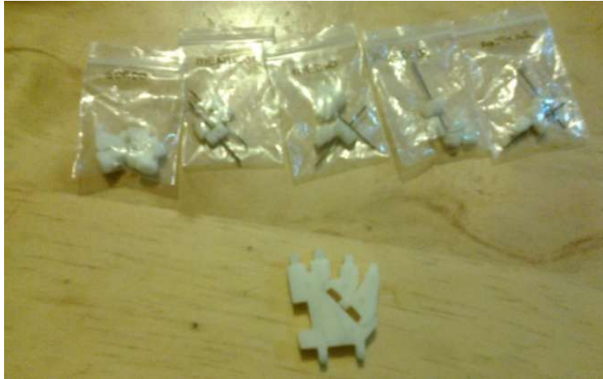
Figura 10-2: Piezas de los dedos y mano impresas a una escala 35,3%
