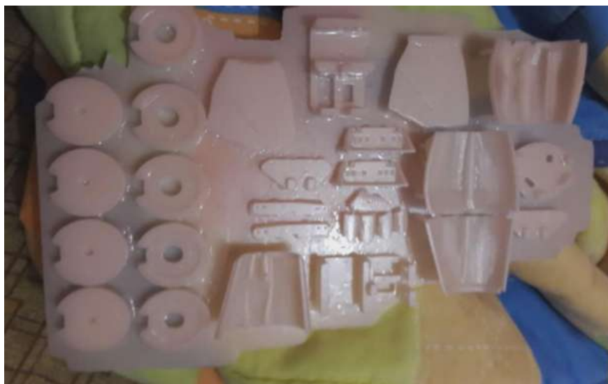
Figura 6-2: Piezas mano, muñeca tratadas después de salir de la impresora 3D de ABS
