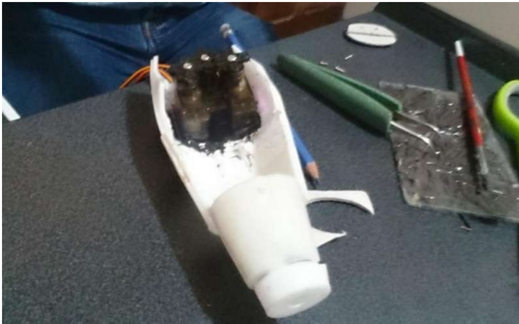
Figura 17-2: Micro servos MG90S unidos al antebrazo
