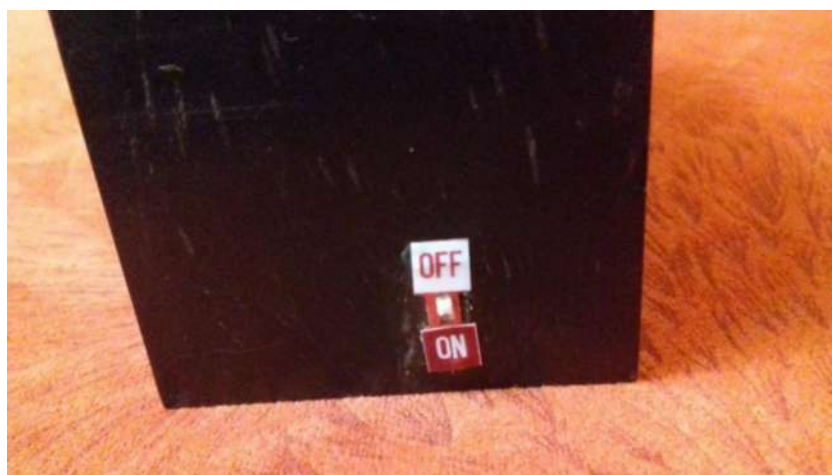
Figura 40-2: Switch de encendido y apagado de la Prótesis Mioeléctrica
