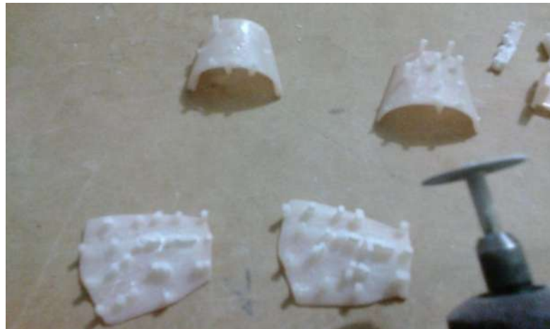
Figura 7-2: Piezas de mano de ABS, proceso de corte de la base
