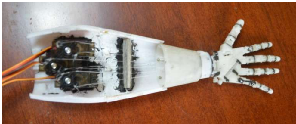
Figura 21-2: Prótesis de brazo izquierdo, incorporado los motores e hilos de nylon
