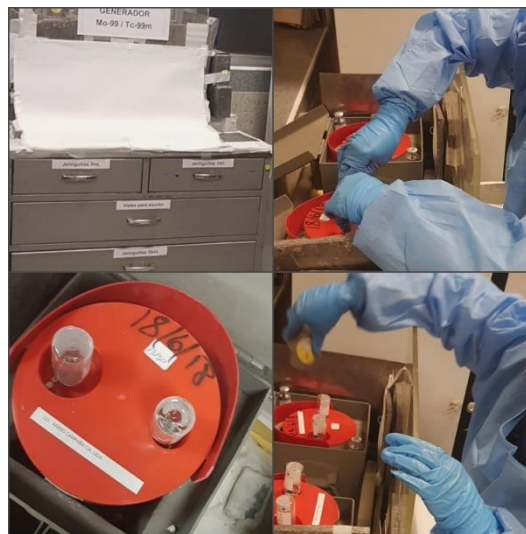
Figura 2-2: Proceso de elución en un generador de "columna seca" Realizado por: Elizabeth Manobanda. 2018
