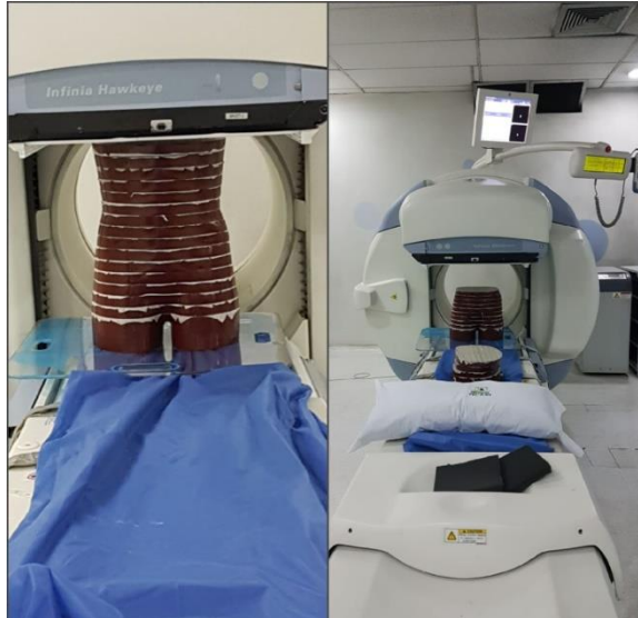
Figura 3-3: Adquisición de datos con el fantoma antropomorfo y gammacámara Infinia Realizado por: Elizabeth Manobanda. 2018
