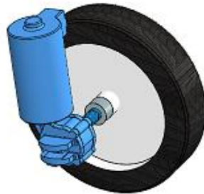
Figura 35- 2: Acoplamiento final de la llanta y el motor Realizado por: Yancha. O. y Castillo. Y. 2017
